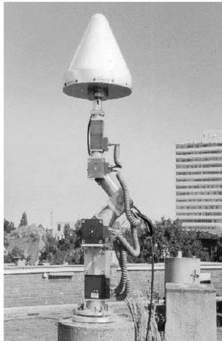
Рис. 1 Установка для абсолютного калібрування антен в реальному часі
