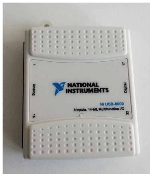
Рисунок 2.8. АЦП-ЦАП тензометричної сервокерованої установки (пояснення в тексті).
