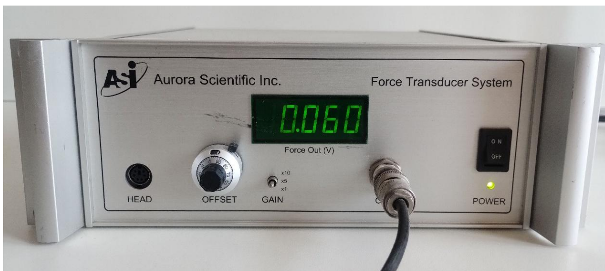
Рисунок 2.7. Система механоконтролю Aurora Scientific тензометричної сервокерованої установки (пояснення в тексті).
