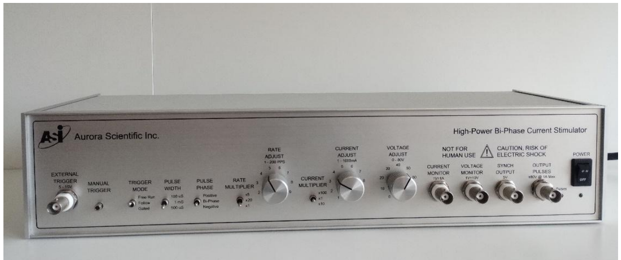
Рисунок 2.5. Двофазний стимулятор електричних імпульсів. (пояснення в тексті).
