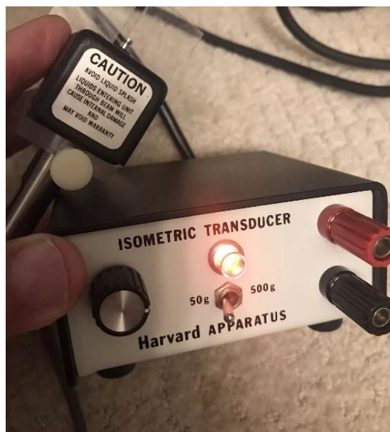
Рисунок 2.6. Датчик сили Harvard 50-500 тензометричної сервокерованої установки (пояснення в тексті).
